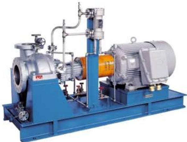
Нефтяные насосы для процессов на нефтеперерабатывающих заводах, полностью соответствующие последней редакции стандарта API610. Центральная опора обеспечивает максимальную жесткость и нейтрализует температурное расширение. Тангенциальное расположение напорного патрубка обеспечивает максимальный гидравлический КПД. Также поставляется с расположением всасывающего патрубка сверху (Модель 3710).
